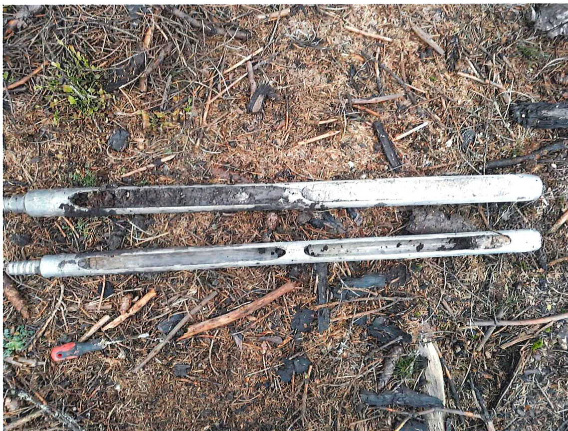
Obrázek 23: Petrografické jádro průzkumné sondy BRDY 2
